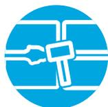
**1.** Usando un hacha o martillo pequeño, retire cualquier exceso de mortero que sobresalga de las juntas de cemento en el muro, así como cualquier otro desperfecto que no forme parte de la superficie.
