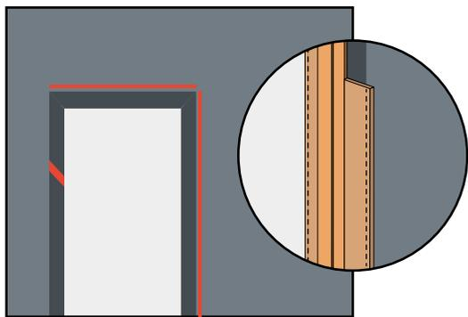
Arma las dos piernas y el cabezal colocando el marco más las dos extensiones, únelos con clavos de 3/4 in. cada 25 cms.
